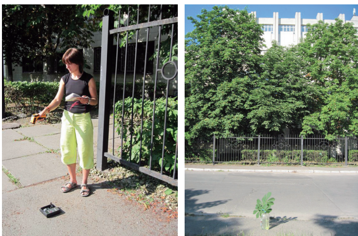
Рис. 4. Процес вимірювання температури асфальтового покриття на відкритому сонці та у тіні
