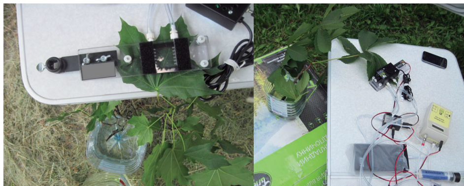
Рис. 3. Вимірювання балансу поглинання та вивільнення \text{CO}_2 листковою поверхнею різних видів паркових дерев (липень, 2016)
